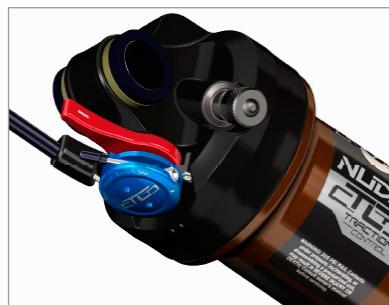
6. und befestigen Sie eine Kabelendhülse mit Hilfe einer Zange.
